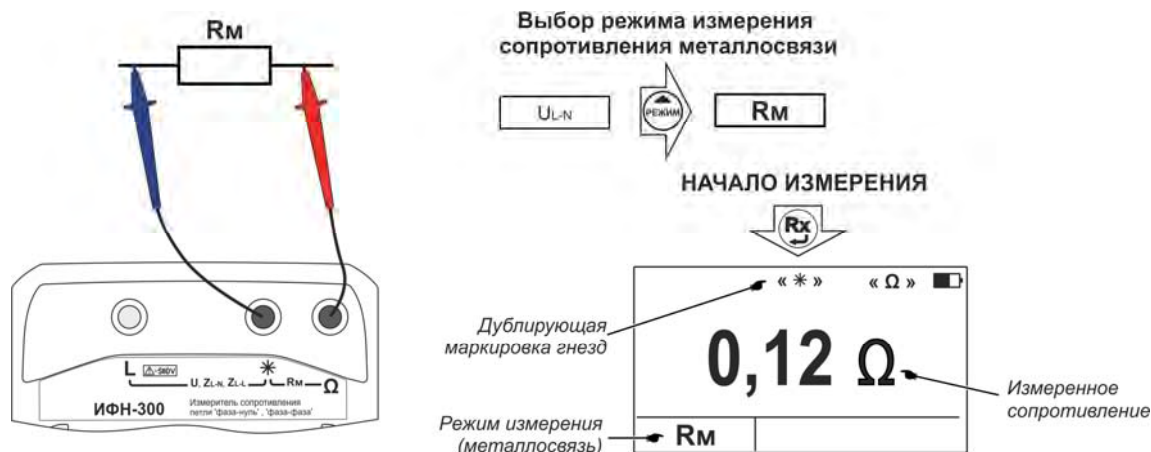
Рисунок 2.7 - Измерение сопротивления металlosвязи
